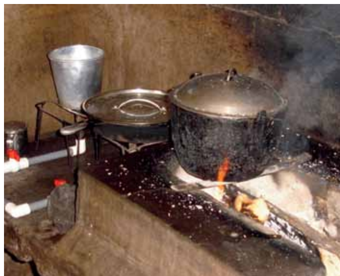
Una estufa de biogas (izquierda) y una de leña tradicional (derecha). Foto: BNPP
